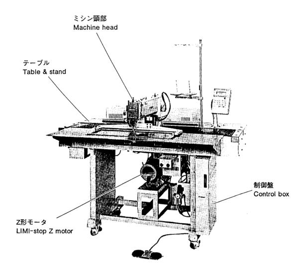
注1:モータ部分は三菱リミストップZクラッチ:モータの部品カタログ(P-007B)を参照ください。 注2:Fig. No. の採番していない部品は単体で支給することは出来ません。Setにて支給致します。 Remarks 1) Concerning to Motor Prease refer to the parts catalog of MITSUBISHI LIMI-STOP Z motor (P-007B) Remarks 2) The parts not taken Fig. No. can not be supplied each parts.
